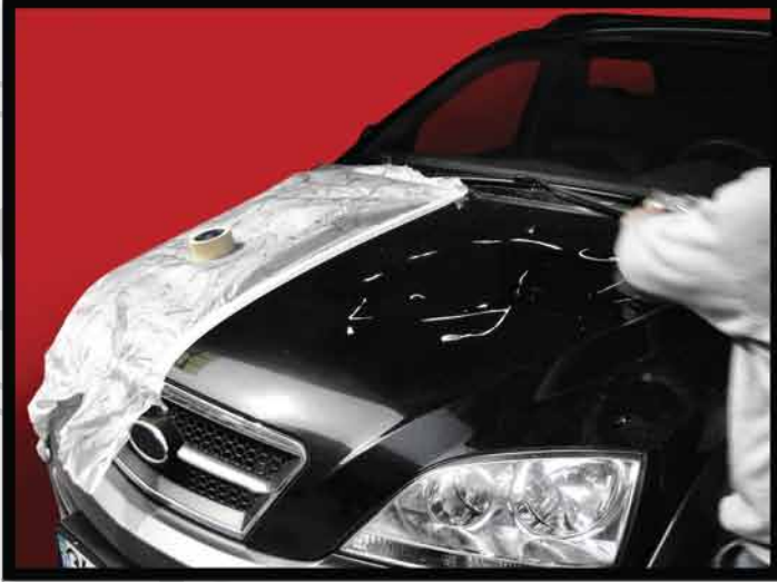
PASTA KALIN ÇİZİK yüzeye makine 1500-1800 devir ile uygulanır.
